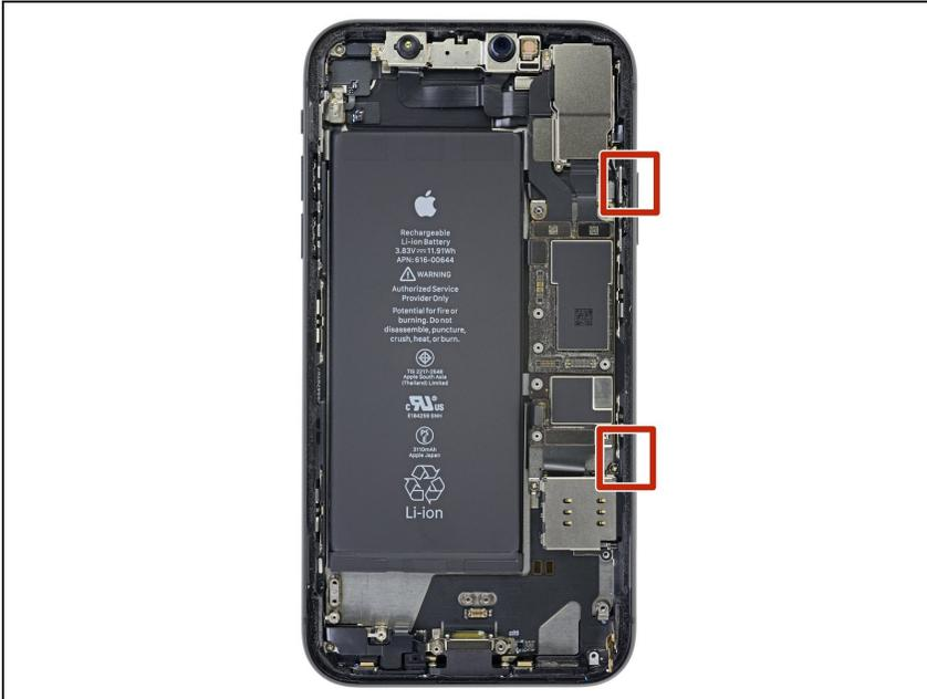
⚠️ iPhoneの右側に端に沿って、デリケートなケーブルが装着されています。この部分にピックを差し込まないでください。ケーブルを破損する恐れがあります。
