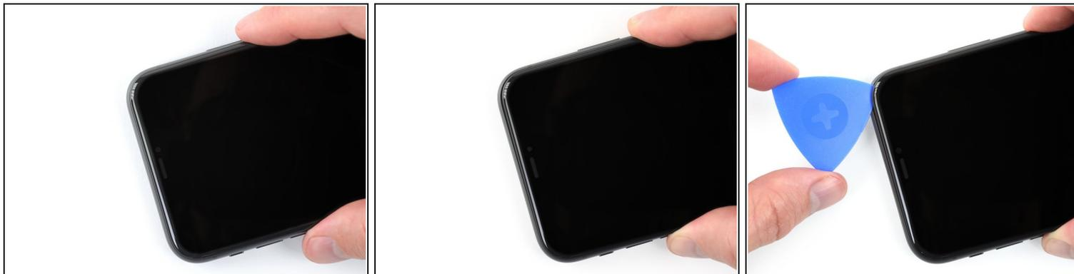
① ディスプレイの上部端は接着剤とクリップ両方によって固定されています。
