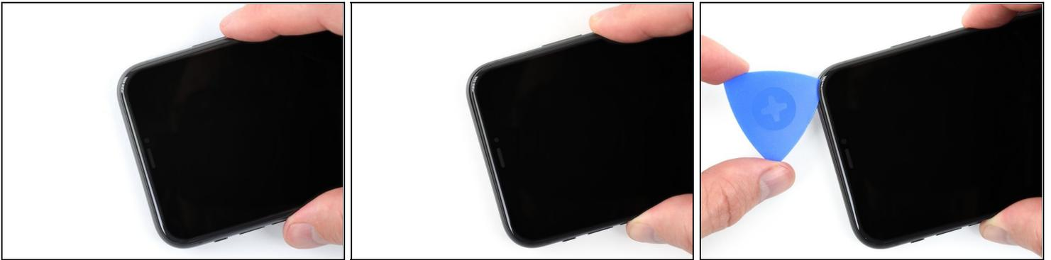
ⓘ Die Oberkante des Displays ist mit Kleber und mit Rasten befestigt.
