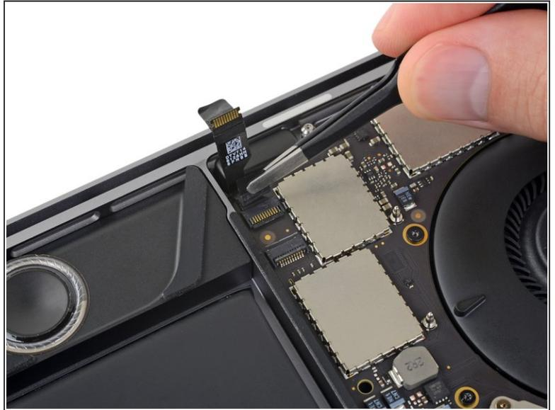
❗ ツイーターのフレックスケーブルの下には、2番目の左側メインスピーカー用ZIFコネクタが搭載されています。
