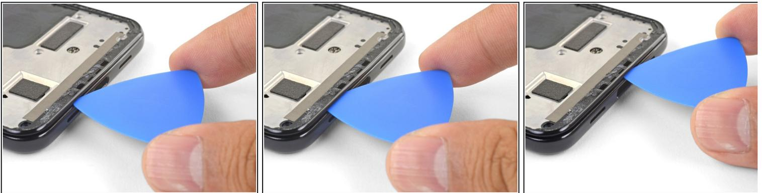
① ミッドフレームはプラスチックのクリップでまだ固定されています。
