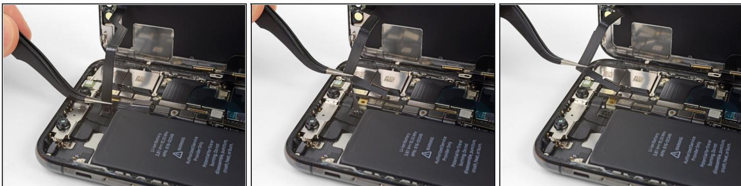
① フロントパネルのセンサーアセンブリのフレックスケーブルは軽く接着剤で留められています。
