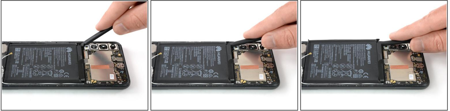
❗ バッテリーを上手くこじ開けられない場合、接着剤が十分に柔らかくなっていない可能性があります。バッテリーの各コーナーの下に、イソプロピルアルコールを塗布し、約2分間浸透させて、接着剤を弱めてください。
