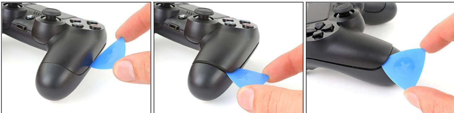
① 6つのプラスチッククリップが、リアケースをフロントケースに固定しています。次の4つのステップでは、コントローラを開ける前に、これらのクリップを外す方法を説明します。
