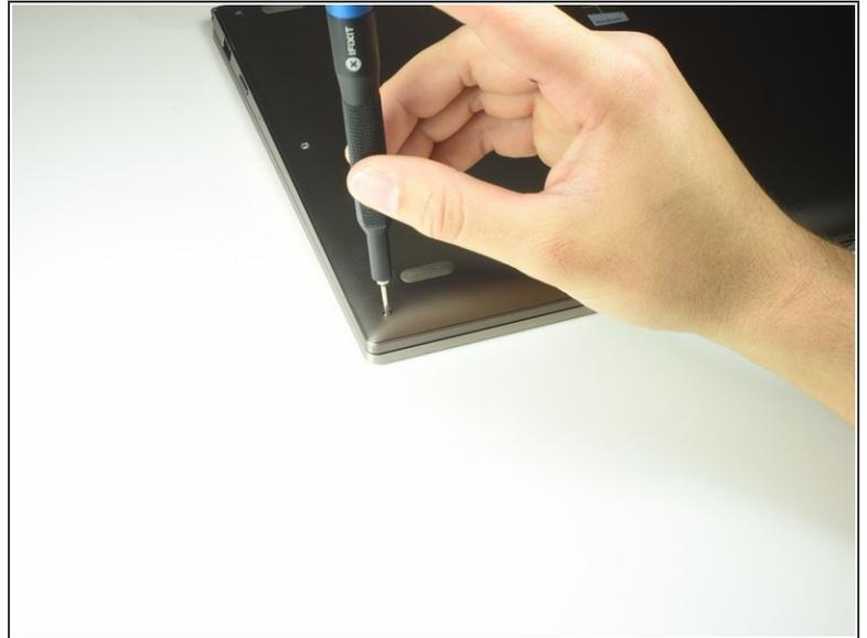
① デバイス本体を裏返して、バックカバーに取り付けられたネジにアクセスします。
