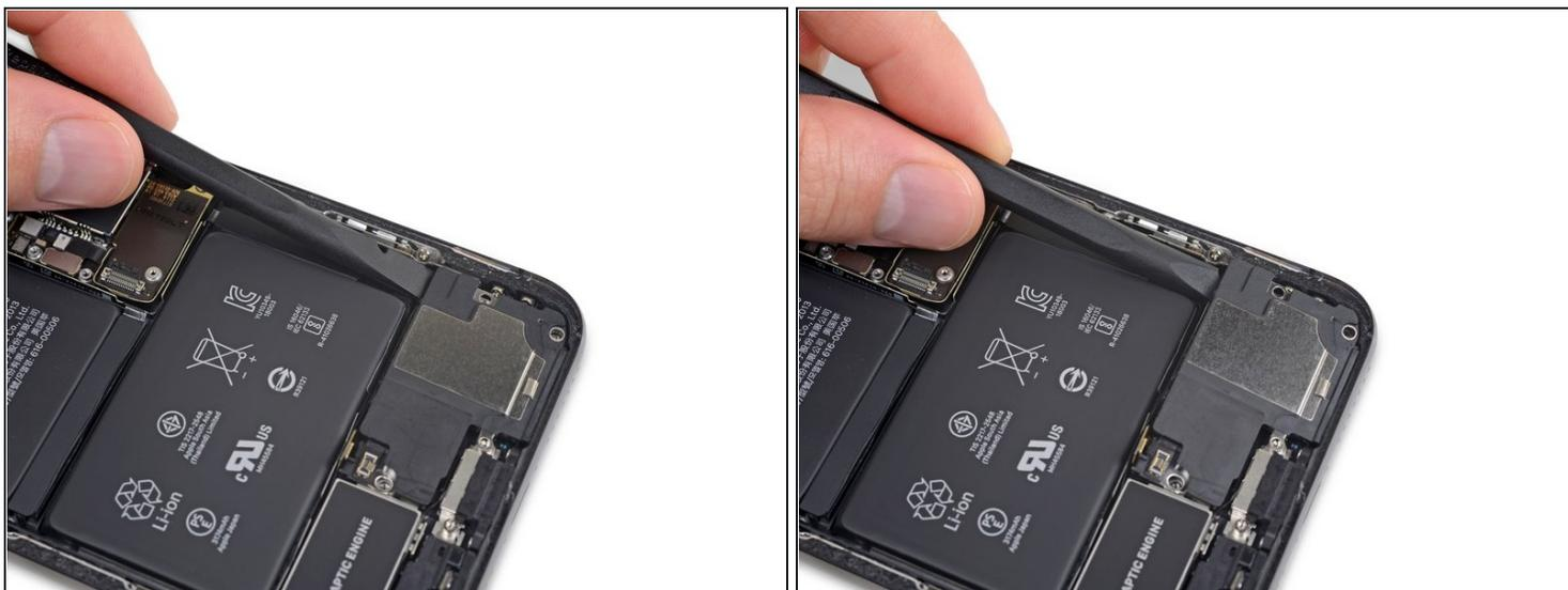
**⚠** スピーカーをこじ開ける際は、接続を外したスピーカーのフレックスケーブルにダメージを与えないよう特にご注意ください。必要に応じて、ケーブルをバッテリー側に曲げて固定します。スピーカーを取り出せる十分なスペースを作れます。
