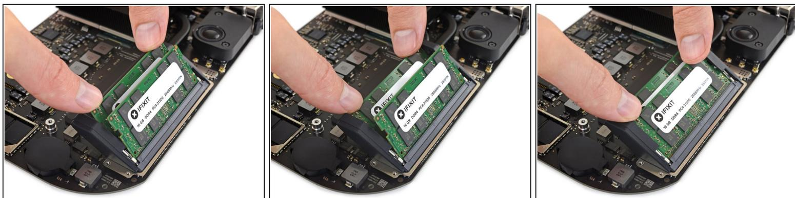
☑️ 最後に、各RAMの上部端を手で支えながら、両側がカチッと音がしてしっかり装着するまでロジックボード側に向けて押し込みます。
