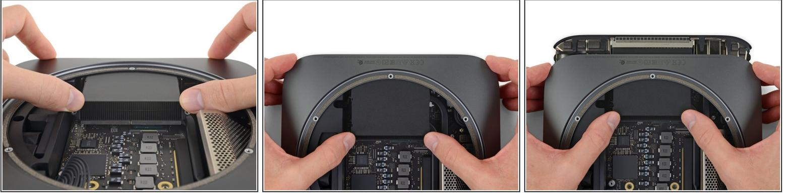
**⚠** この手順では、ロジックボードをフレームに固定しているクリップから押し出します。指示された場所のみ押してください。デリケートなクーリングフィンが損傷する可能性があります。
