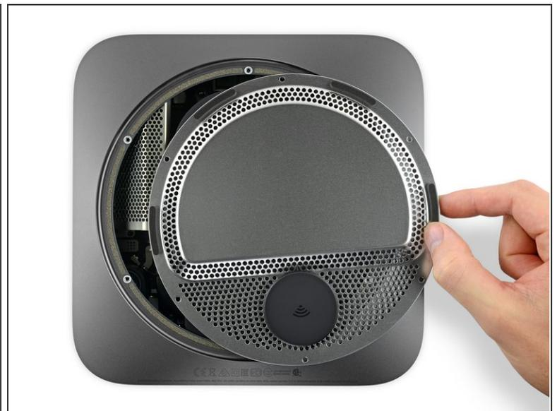
**⚠** アンテナプレートを完全に取り外さないでください。これはまだアンテナケーブルがMac miniに接続されている状態です。
