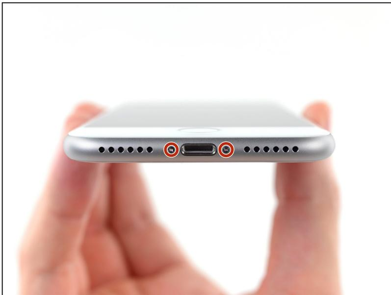
⚠ 作業開始前にiPhoneのバッテリーを25%以下まで放電してください。充電されたリチウムイオンバッテリーは、バッテリーに穴が空いた場合、引火や爆発の恐れがあります。
