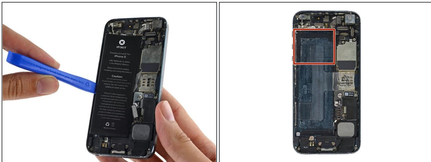
⚠️ プラスチック製の開口ツールを使って端末本体左端のみから挿入し、バッテリーをゆっくりと丁寧に持ち上げます。この箇所以外の場所、特にロジックボード付近に接触するとロジックボードにダメージを与えてしまうことがあります。
