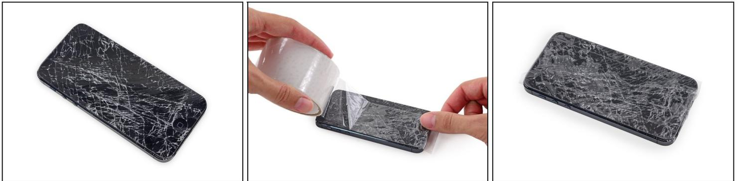
① ディ스플레이のガラスにヒビが入った場合は、テーピングをすることで、それ以上の破損を防ぎ、修理の際の人的被害を防ぐことができます。
