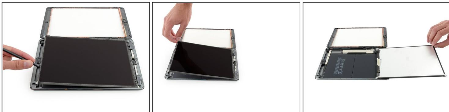
⚠️ LCDを完全に取り外さないでください。まだホームボタンの端にいくつかのケーブルとiPad本体が接続されています。前面カメラ側からのみ持ち上げます。
