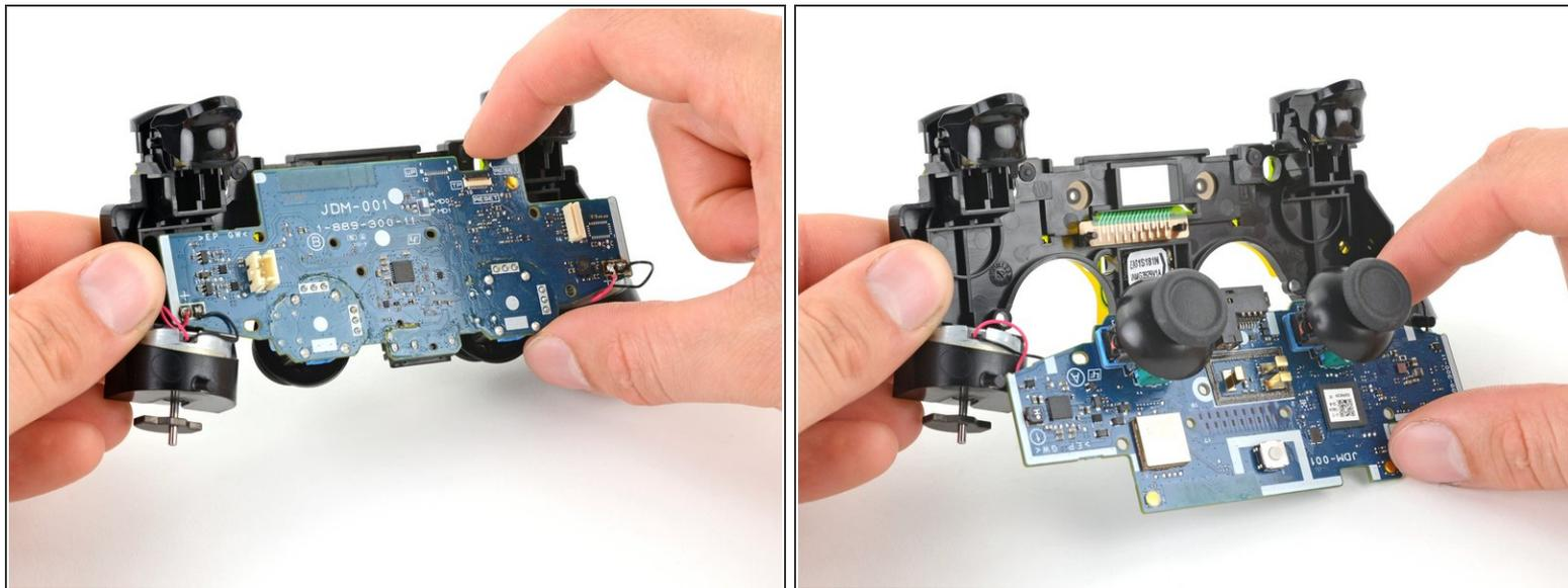
**⚠** 振動モーターのケーブルに負担をかけないように注意してください。振動モーターがマザーボードから外れた場合、[このガイド](#)に従ってはんだ付けをやり直してください。
