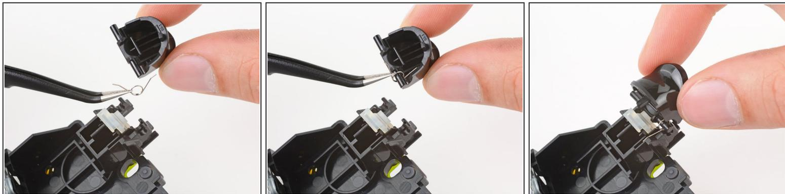
☑ 再組立の際には、以下の手順でR2ボタンとL2ボタンにスプリングを取り付けてください。
