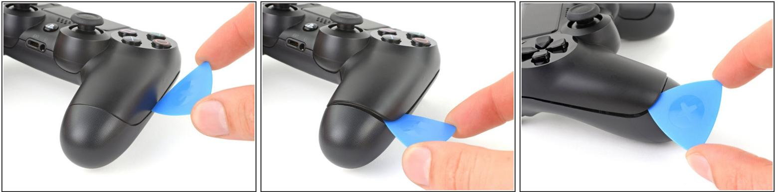
**i** 6つのプラスチッククリップが、リアケースをフロントケースに固定しています。次の4つのステップでは、コントローラを開ける前に、これらのクリップを外す方法を説明します。
