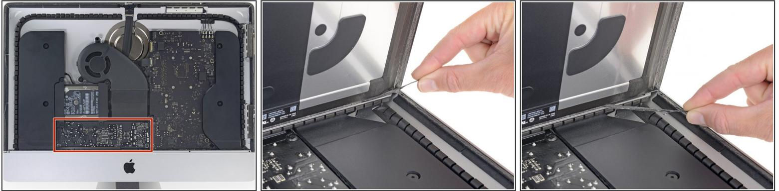
**⚠ 必要に応じて、プラスチックカードを使って、下側に残っている接着ストリップを削ぎ落としてください。**
