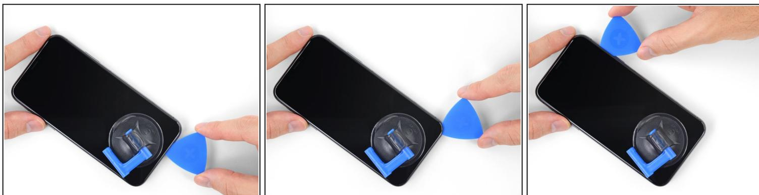
● iPhoneの下側端に開口ピックを再挿入してください。今度は右側に向けてスライドして圧着材を切り込みます。
