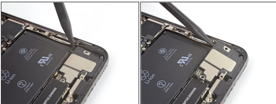
**⚠** スピーカーを取り出す時、接続を外したフレックスケーブルにダメージを与えないようご注意ください。必要であれば、ケーブルの一方の端を持ち、スピーカーが取り出せるスペースを作ってください。
