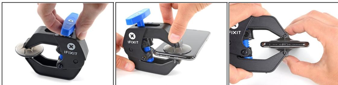
① 次の3つの手順では、デバイスの開講作業を簡単にするために開発されたツール、リバースクランプの使い方を紹介します。リバースクランプを使用しない場合は、この3つの手順をスキップして別の方法をご覧ください。
